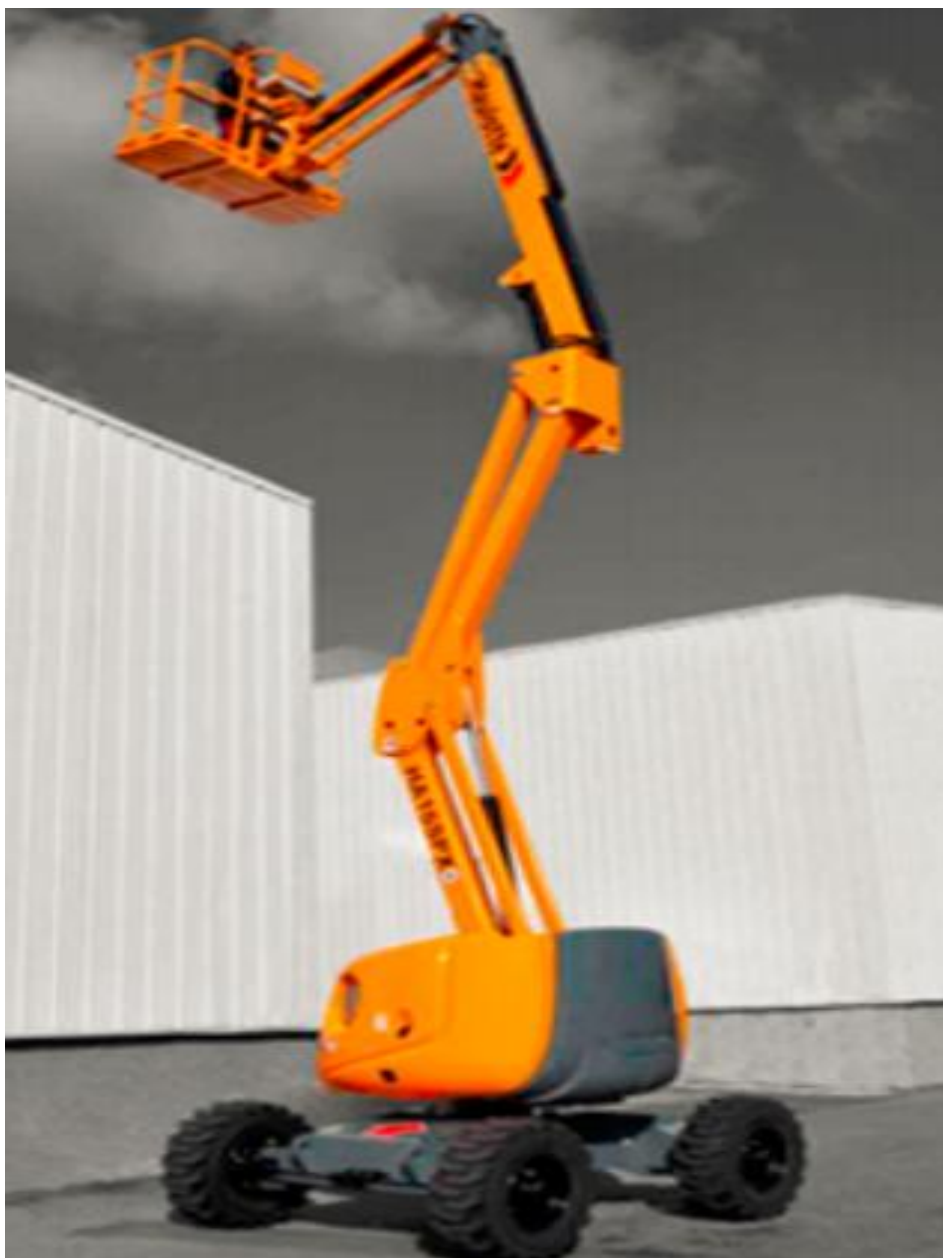
Obr. A3.12 Montážní kloubová plošina HAULOTTE GROUP HA 16SPX, zdroj: http://www.gigarental.com.br/Haulotte.html
