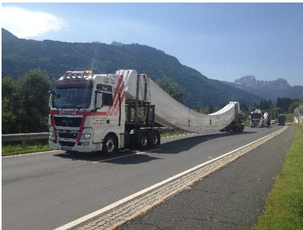
Obr. A5.4 Souprava pro přepravulepených obloukových vazníků
