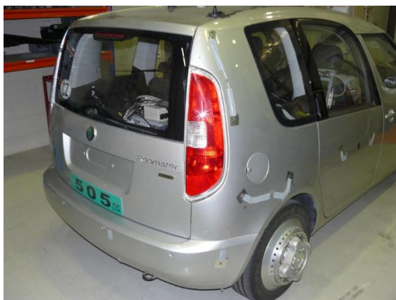
Obr. 38 Konfigurace BASE s měřicími koly
