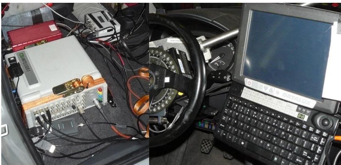
Obr. 58 Ústředna Multidata umístěná místo zadní sedačky a ovládací jednotka řidiče
