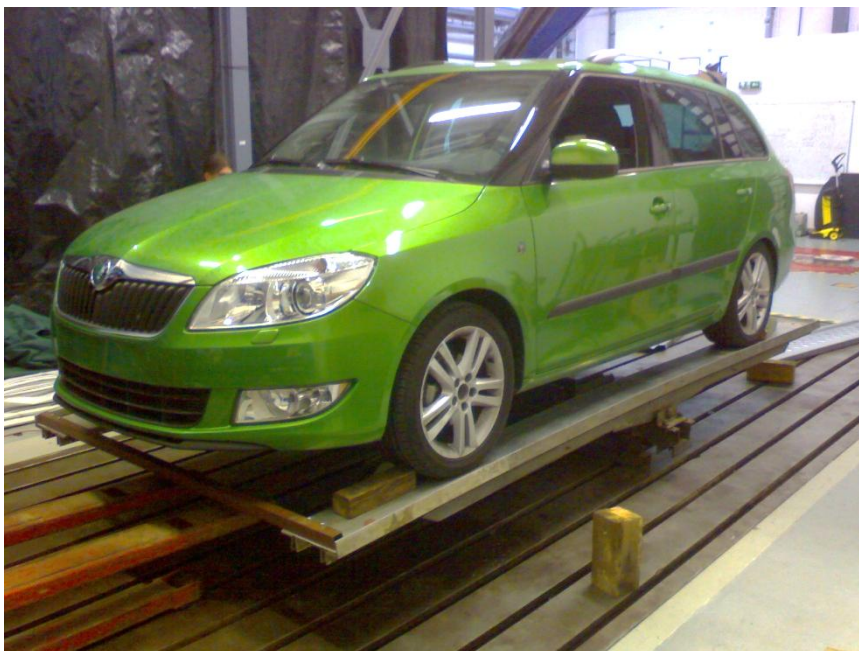
Obr. 31 Ukázka z měření momentu setrvačnosti
