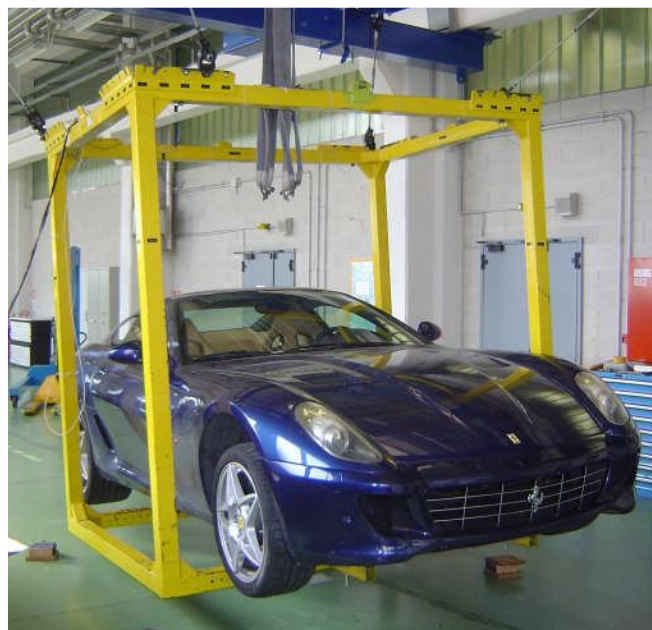
Obr. 29 Příklad aplikace závěsné metody pro měření vozidla [42]
