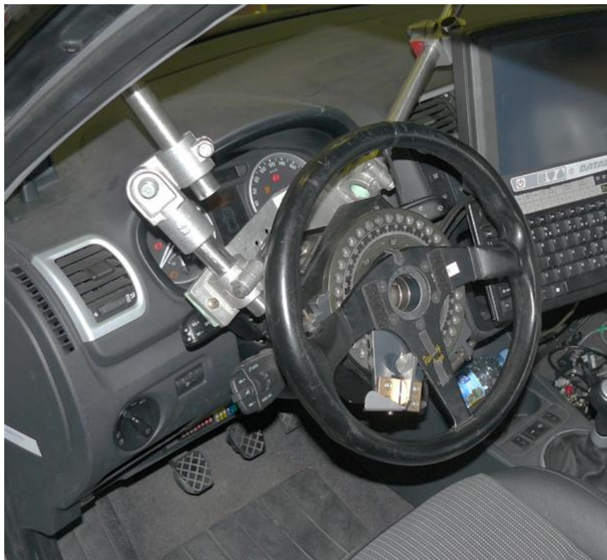
Obr. 54 Měřicí volant RMS FEL 20 s držákem
