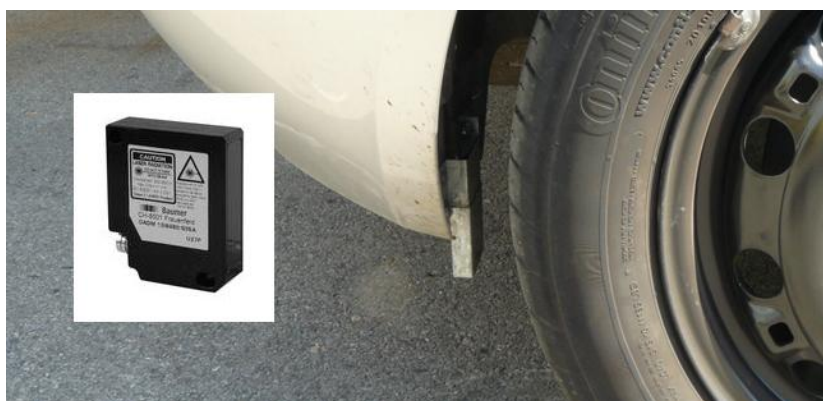
Obr. 57 Snímač Baumer OADM 13 a jeho umístění na vozidle [48]
