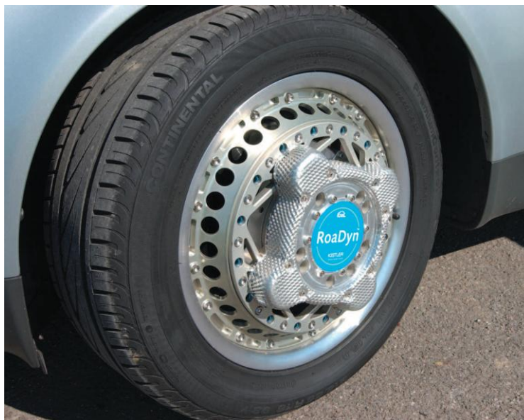
Obr. 56 Měřicí kolo Kistler RoaDyn P625 [47]
