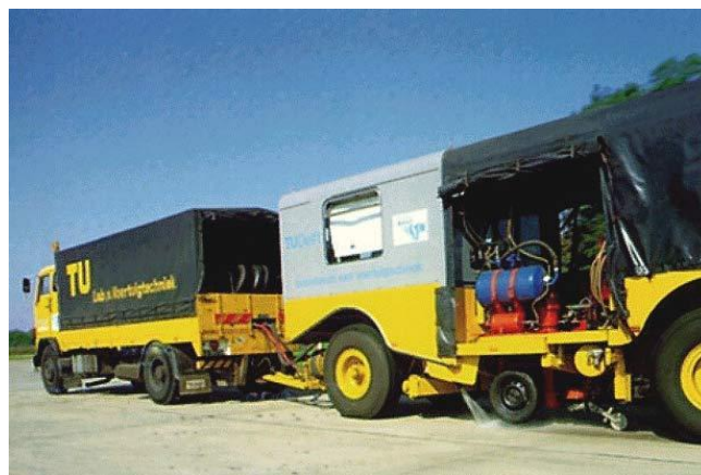
Obr. 25 Speciální přívěs pro testování pneumatik [39]
