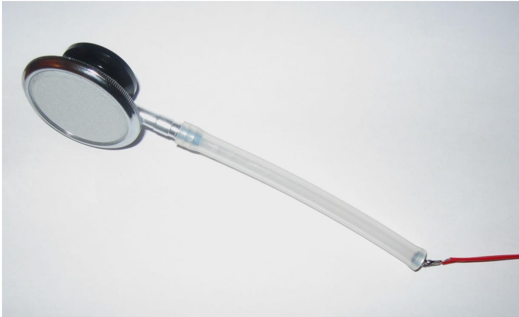
Obr. 4.3 - Fonendoskop s elektretovým mikrofonem
