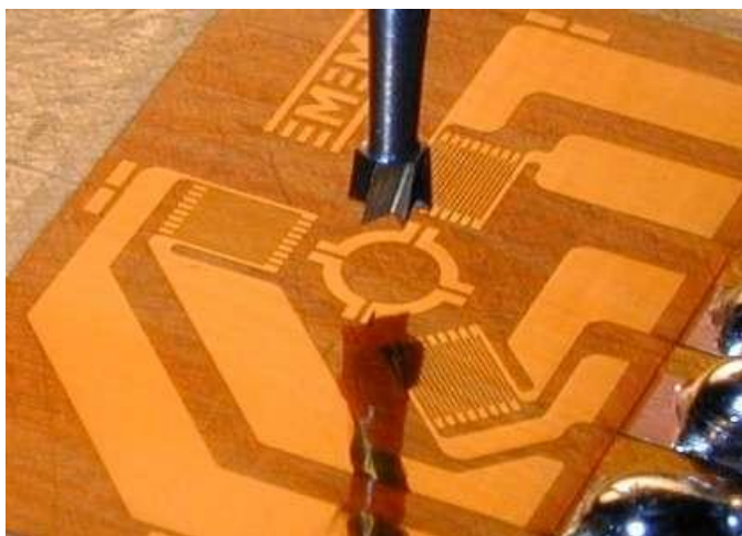
Obrázek 11 Nalepovací přípravek s tenzometry pro měření deformace vyvrtané díry [13]
