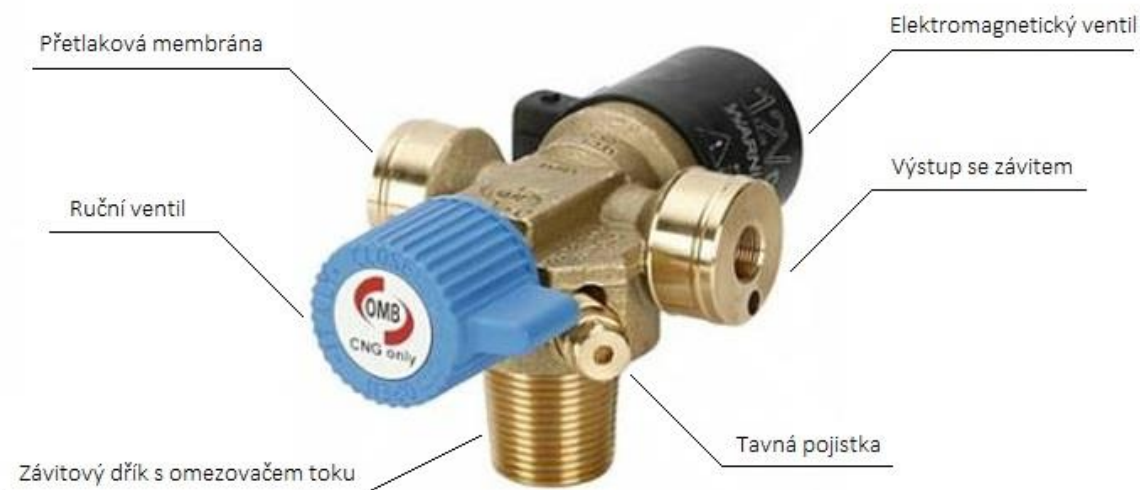
Obr. 12 Skupina ventilů na tlakové nádobě [23]
