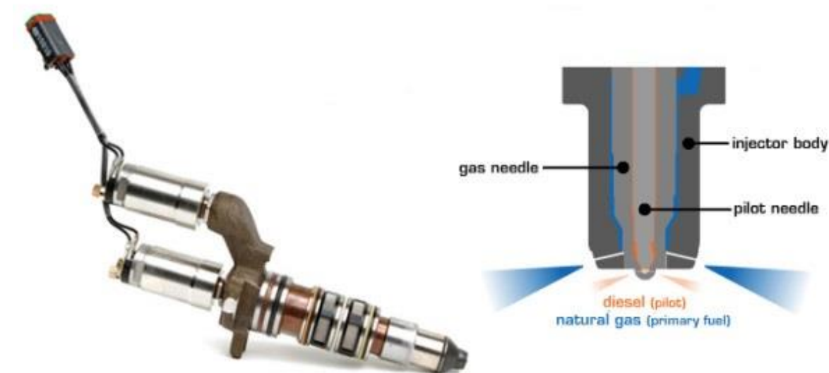
Obr. 17 Speciální vstřikovač nafty a zemního plynu [47]
