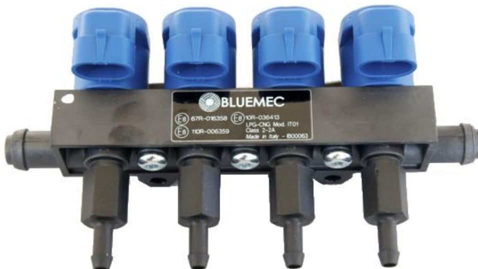
Obr. 15 Elektronicky řízené vstřikovače se sběrným potrubím [49]
