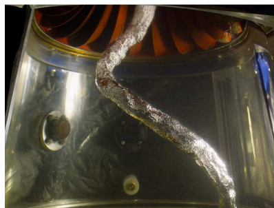
Obr. 3 Vírový cop v sací troubě Francisovy turbíny při podoptimálním průtoku [16]
