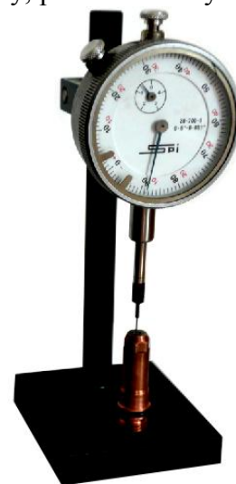
Obr. 4.12 Měření vypálení elektrody
