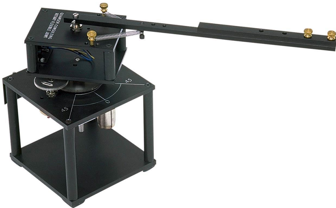
Obrázek 5.1 Přípravek rotační kmitavé soustavy od firmy QUANSER [8]
