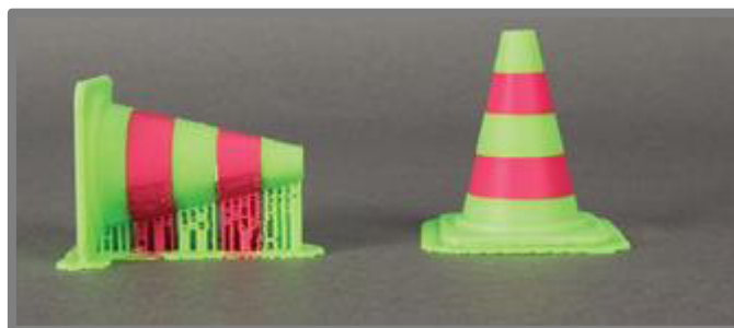
Obr. 3 Ukázka podpurné konstrukce [6]
