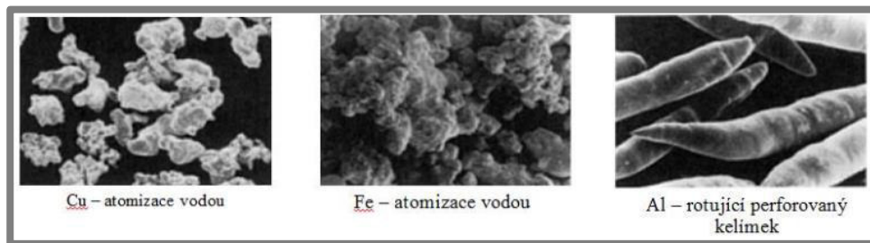
Obr. 17 Struktura částic po atomizaci vodou nebo atomizaci rotací [29]
