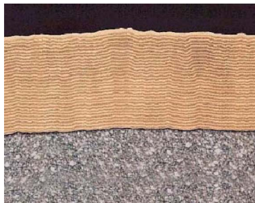
Obr. 2.10 Multivrstvý systém TiN/Ti(C,N) firmy Galenite [27]
