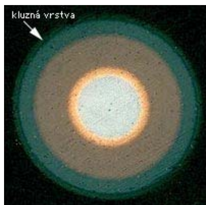
Obr. 2.7 Nanokompozitní povlak Lubrik SI s kluznou vrstvou firmy SHM [46]
