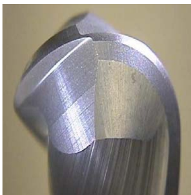
Obr. 3.13 Kulová fréza HX-S firmy Fraisa s směrem výbrusu kolmým k ostří [42]
