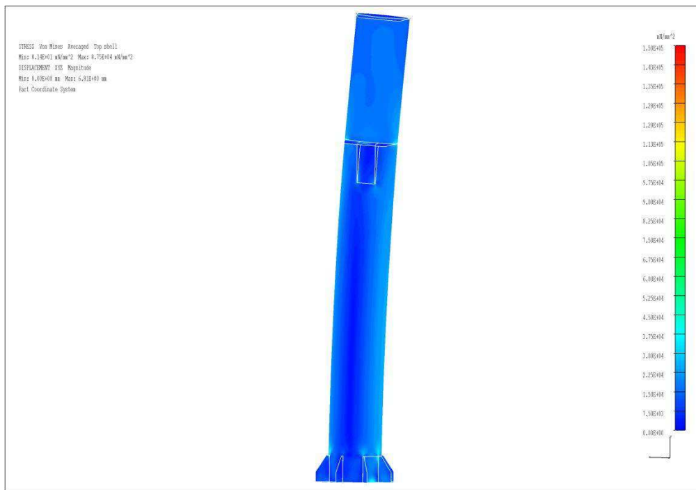
Obr. 24 průběh napětí na sloupu analýzou HMM, 1. zatěžující stav, zobrazení 0-150 MPa, viditelná vrchní část skořepiny, deformace 50x zvětšeny, výložník otočen v proti směru osy z.
