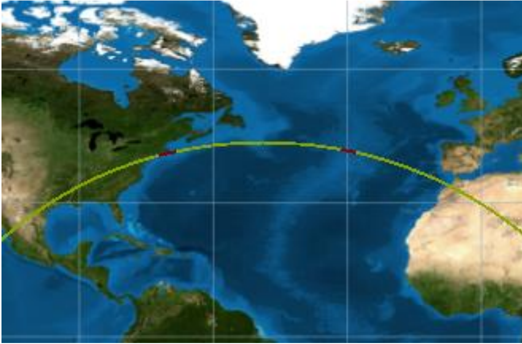
Obr. 4.4: Dráha pozorovací družice se zvýrazněnými oblastmi pozorování zatmění.
