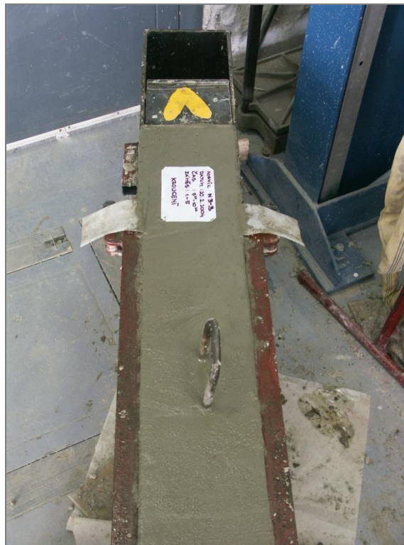
Obr. 14 – Betonáž vetknutého konce
