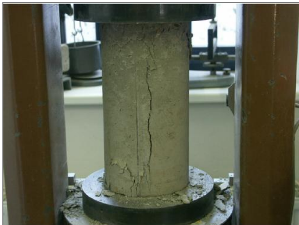
Obr. 18 – Porušený válec (tlak)
