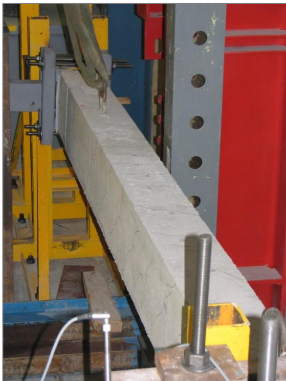
Obr. 21 – Pootočení nosníku N3-1
