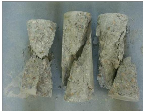
Obr. 19 – Porušené válce (tlak)
