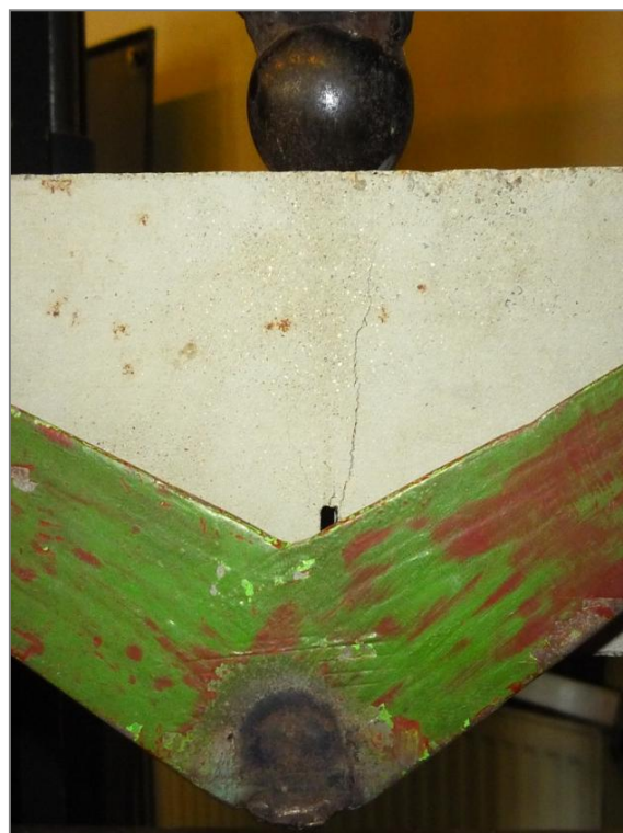
Obr. 20 – Detail: zkouška lomových parametrů
