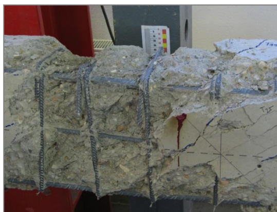
Obrázek 7-26 Detail rozevírání třmínků
