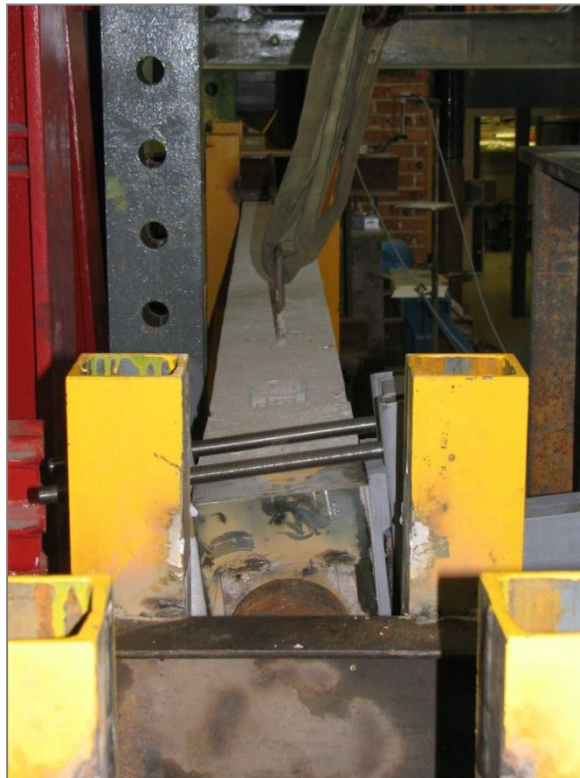
Obr. 22 – Pootočení nosníku N3-1
