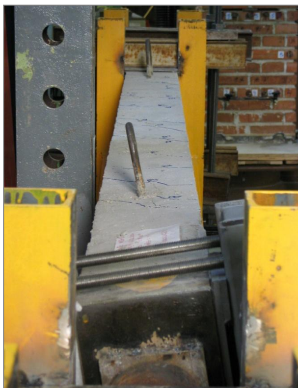
Obr. 22 – Pootočení nosníku N3-3
