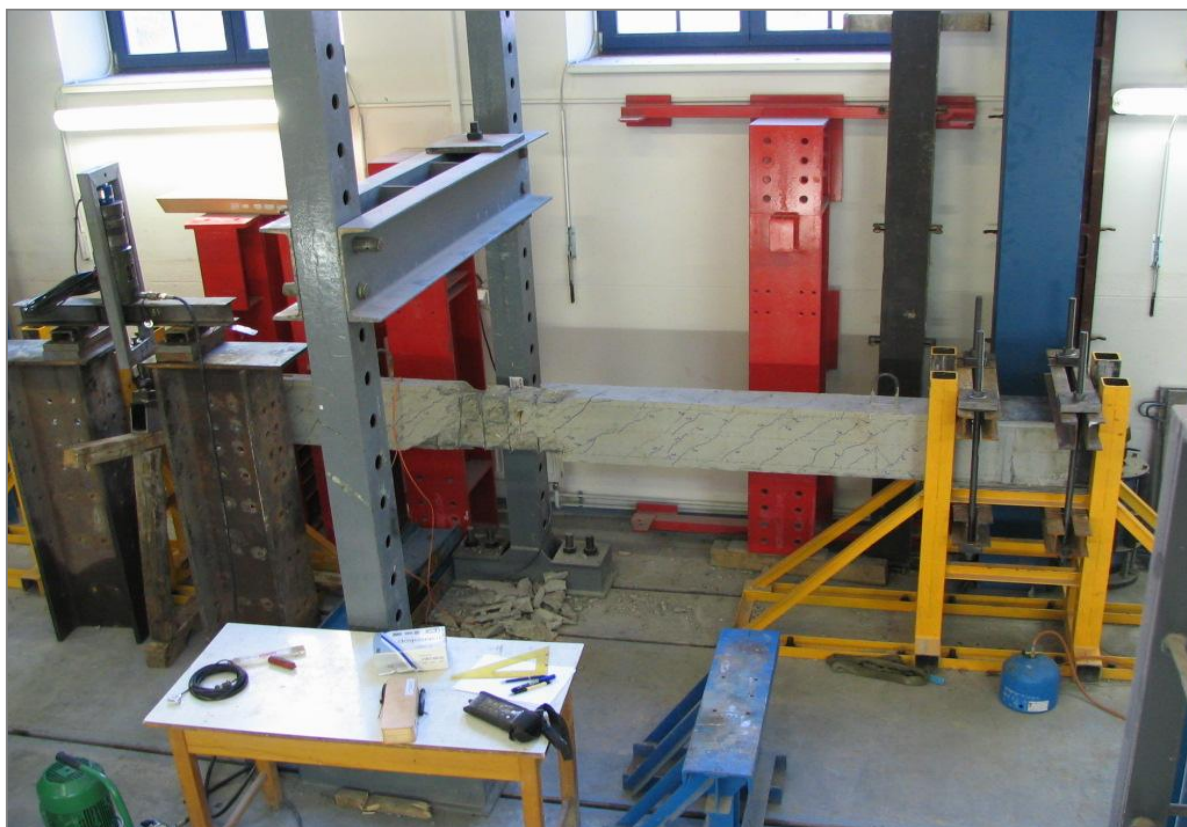
Obr. 23 – Zatěžovací sestava (s porušeným vzorkem)
