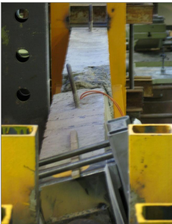
Obr. 21 – Pootočení nosníku N3-2
