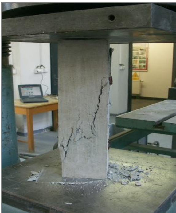
Obr. 18 – Porušený hranol (tlak)
