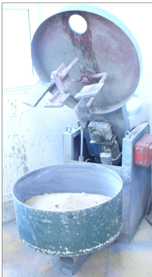
Obr. 11 – Mísení betonové směsi
