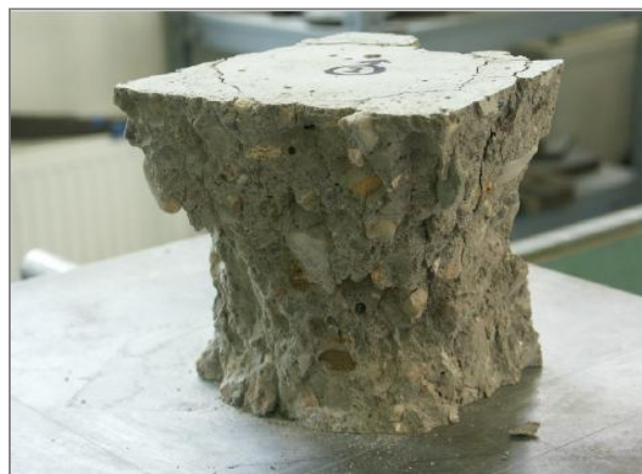
Obr. 19 – Porušená krychle (tlak)
