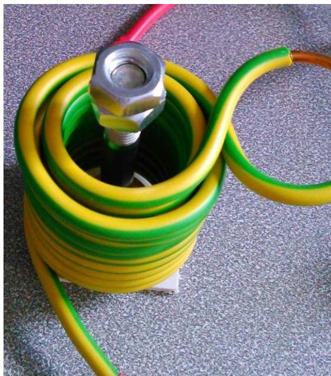
Obrázek 43. Ukázka praktické realizace dvojité cívky pro indukční ohřev
