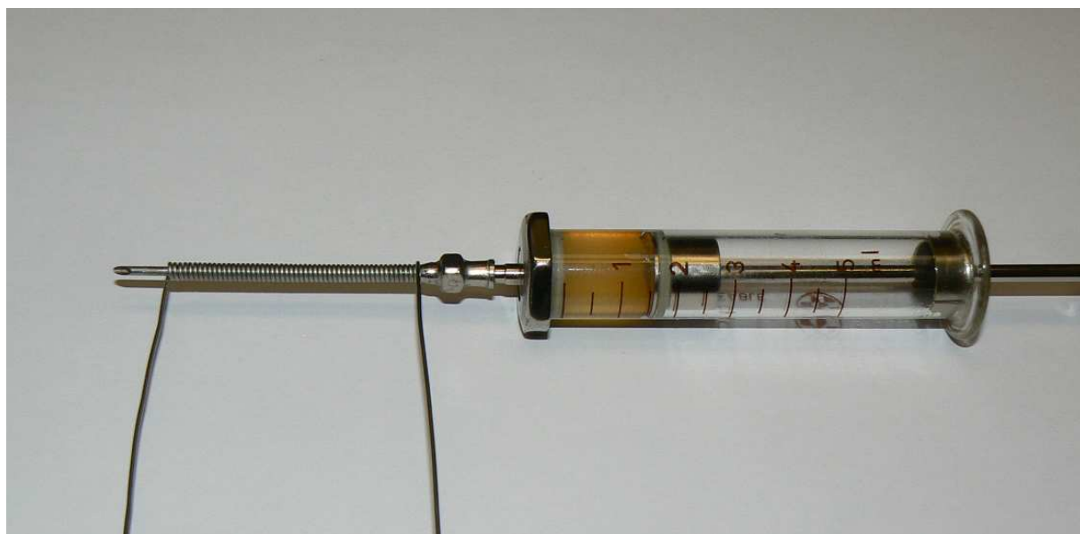
Obrázek 14. Principiální ohřev elektrody kontaktním způsobem
