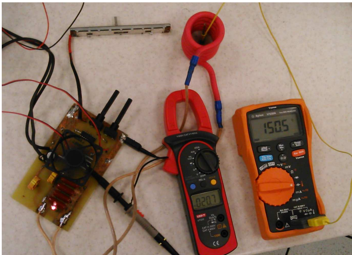
Obrázek 37. Detail měření (střídavý proud I_{PRO}=20 A, teplota T=150 °C)
