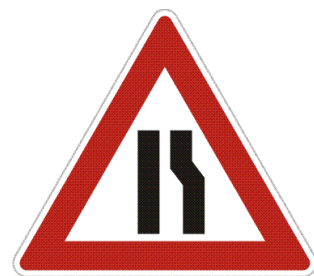
Obrázok č. 19 Zúženie vozovky
