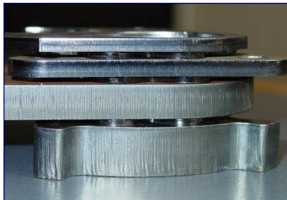
Obr.32 Kvalita řezu konstrukční oceli [9]
