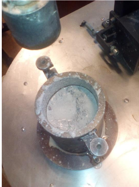
Obrázek 8: Nevydařená zkouška zhutnitelnosti štěrku 0/16 pro w = 11 \%
