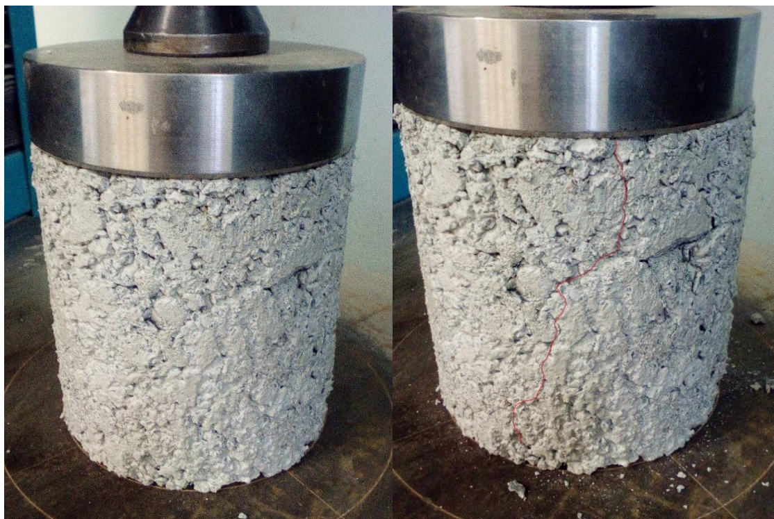
Obrázek 10: Vzorek směsi SC 0/16; C 6/8 před a po zkoušce pevnosti v tlaku R c
