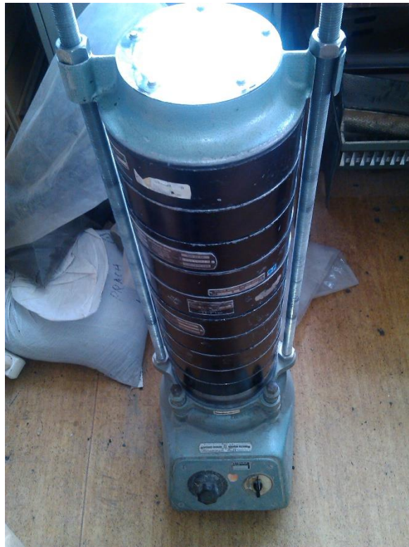
Obrázek 1: Sada sít pro stanovení zrnitosti
