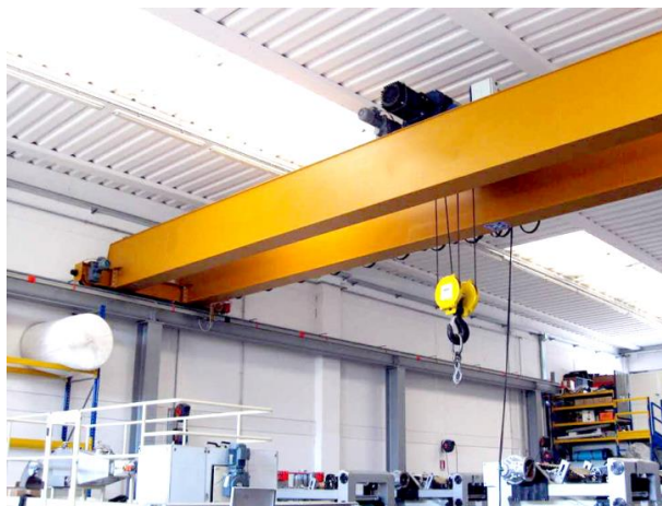
Obr. 2.24. Mostový žeriav spolu s mechanizmom na zavesenie bremena typu háka [12].
