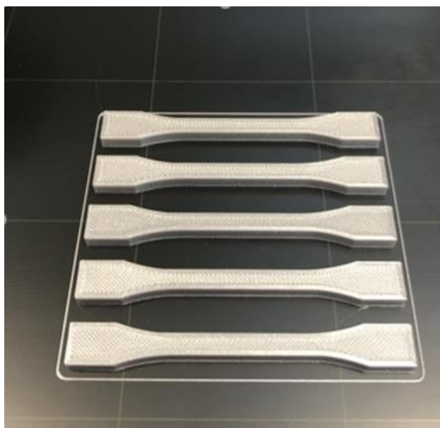
Obr. 22 Vyhotovené zkušební tyče z materiálu PLA.
