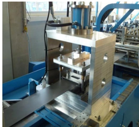
Obr. 32 Stříhání na střižném nástroji. [43]
