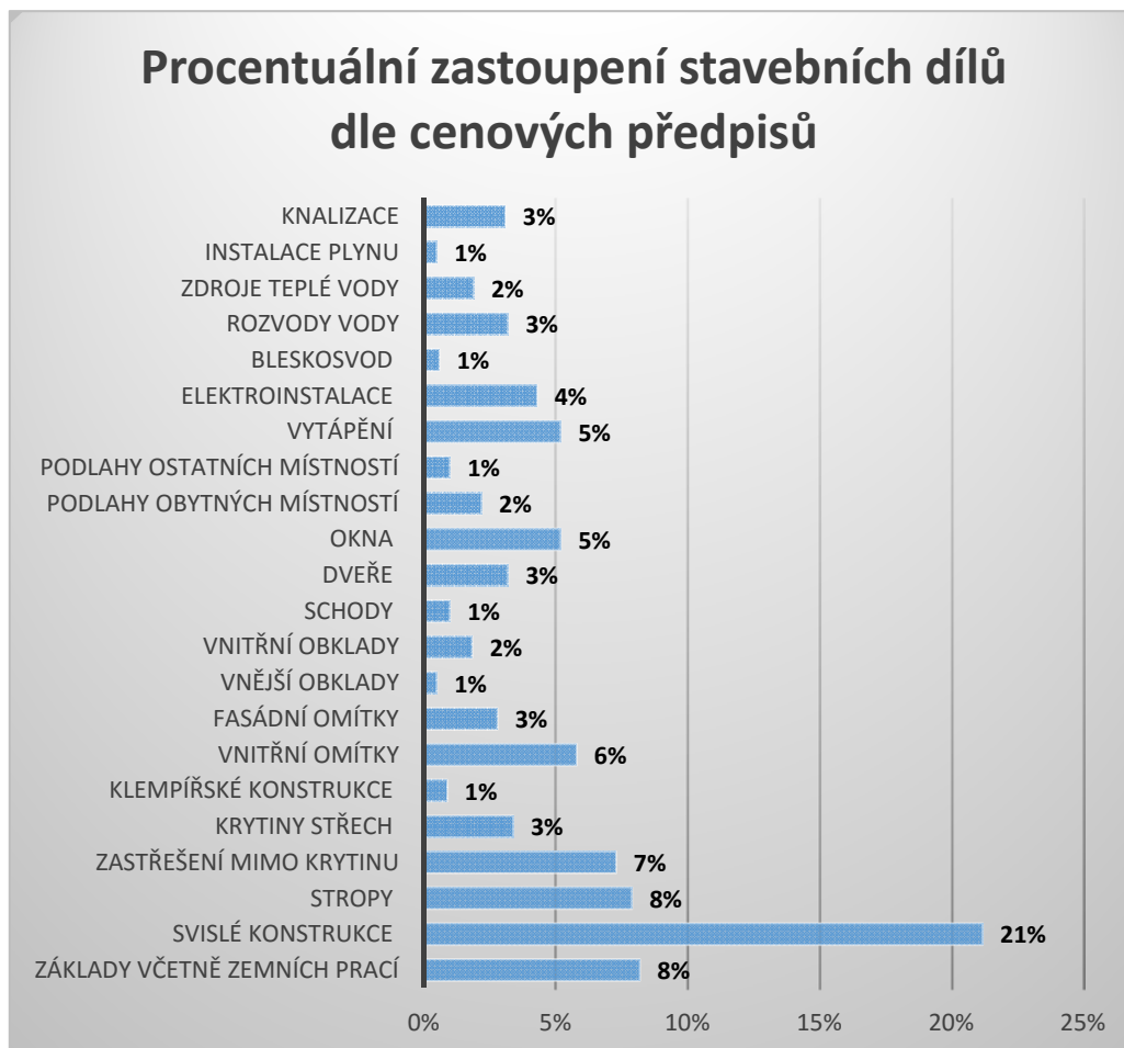
Obrázek 5: Procentuální zastoupení stavebních dílů ve srovnatelné stavbě podle cenových předpisů, zdroj vlastní
