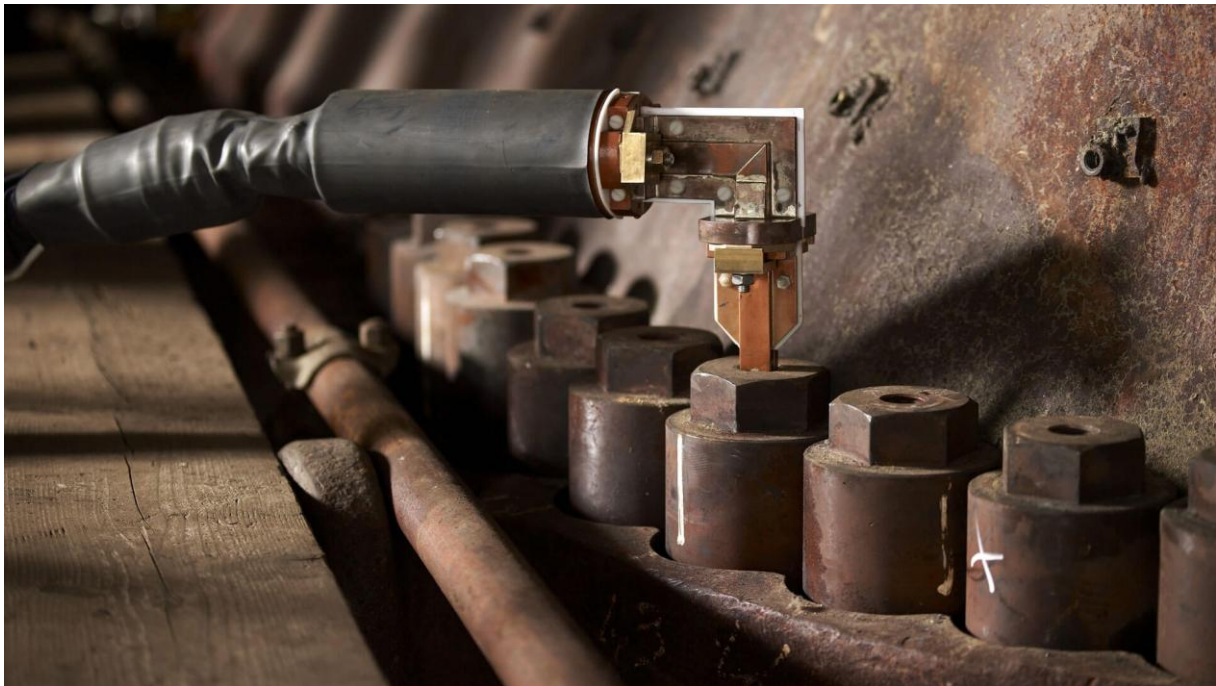
Obrázek č.11: Tepelné roztahování šroubu indukčním topným tělesem [9]
