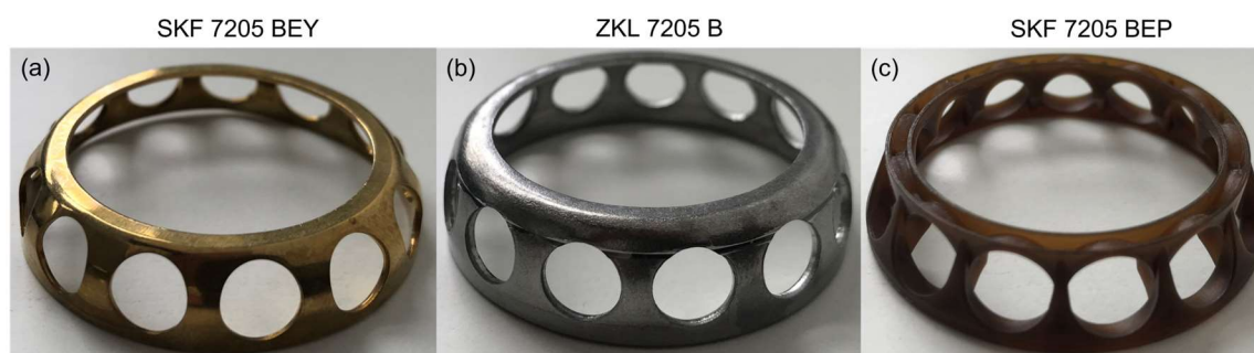
Obr. 4.7 Použité ložiskové klece: (a) mosazná; (b) ocelová; (c) polyamidová
