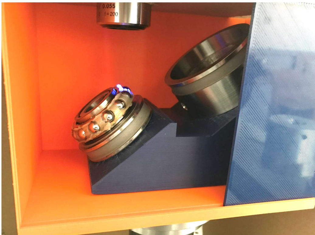
Obr. 4.10 Rozebrané ložisko v přípravku a krabičce při pořizování snímků
