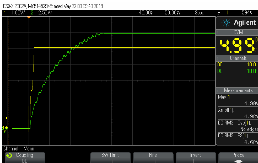
Obr. 5.3: CH1: náběh 5V zdroje, CH2: náběh 15V zdroje
