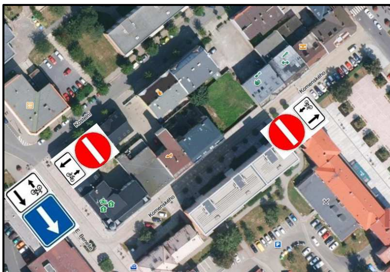
Obrázek 83: Úsek č.4, svislé dopravní značení [20]
