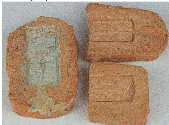
Obr. 3-14 Vnitřek použitých vypálených forem
