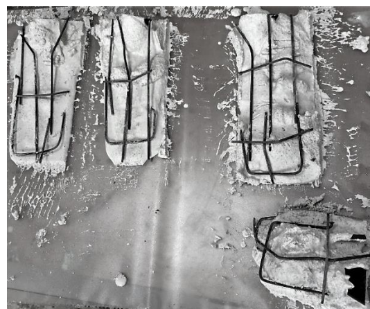
Obr. 3-17 První vrstva sádrové směsi s armováním
