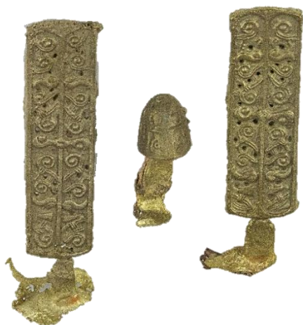
Obr. 3-23 Kvalitou nedostatečné odlitky z hliněných forem
