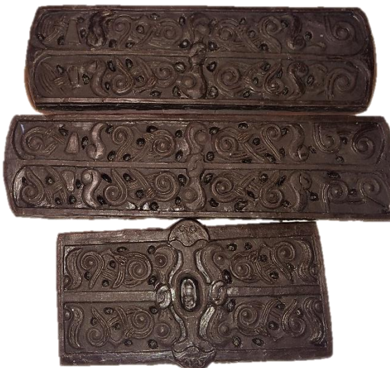
Obr. 3-4 Voskové modely z hnědého syntetického vosku
