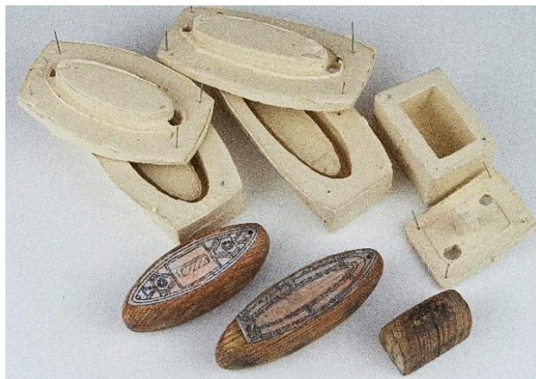
Obr. 3-9 Dřevěné modely a formy na vnitřní kostru jílce
