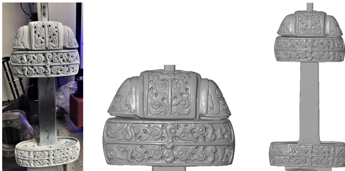
Obr. 3-30 Jílec pokrytý oxidem titanu (vlevo), 3D sken jílce (uprostřed a vpravo)
