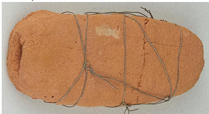
Obr. 3-15 Vyžíhaná a popraskaná hliněná forma zpevněná drátem
