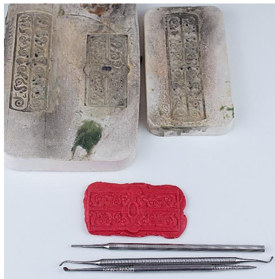
Obr. 3-2 Sádrové bloky, rýcí nástroje a plastelína s kontrolním otiskem vzoru
