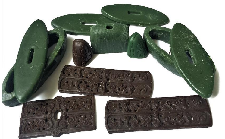
Obr. 3-10 Voskové modely pro lité díly jílce
