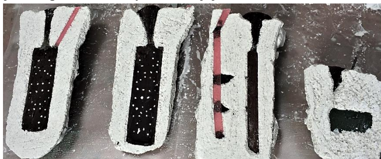
Obr. 3-18 Otočené formy připravené k formování zadní strany
