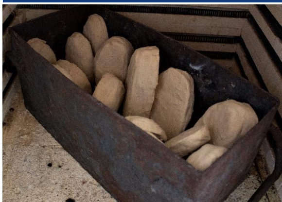
Obr. 3-20 Vytavování voskových modelů
