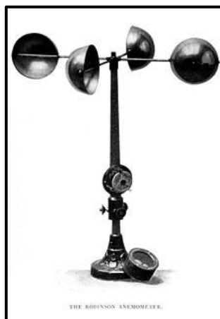
Obr. 2.1 Robinsonův mechanický anemometr [2]
