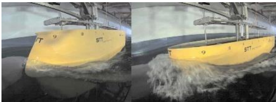
Obr. 30: Porovnání provedení X-bow s normální přídí při průchodu vlnou[80]
