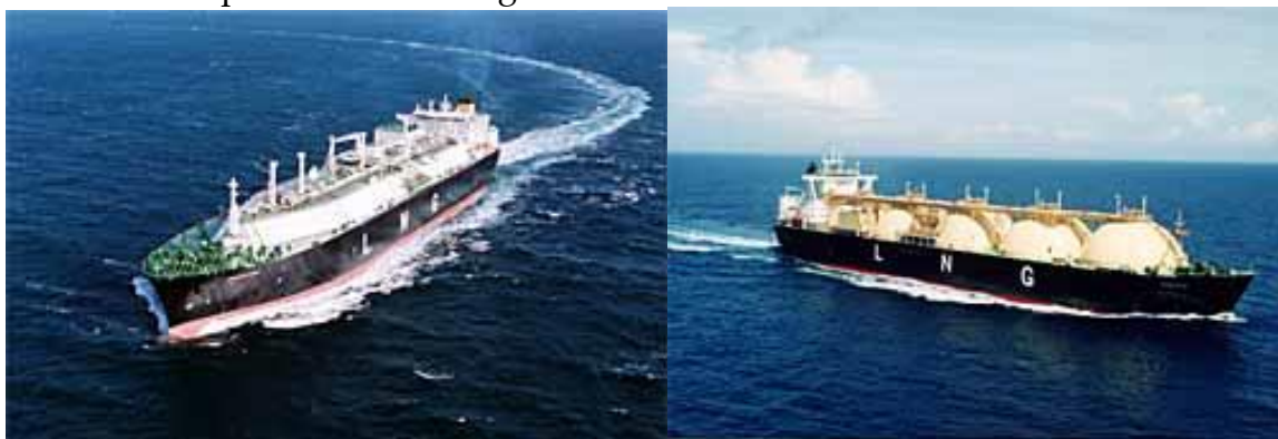
Obr. 1 Tankery Granatina (Membránová nádrž provedení GT96 s kapacitou 140500 m 3 ) a Galea (Sférická nádrž provedení Moss s kapacitou 135000 m 3 ), náležící společnosti Shell International Trading and Shipping Co Ltd (STASCO)[51]
