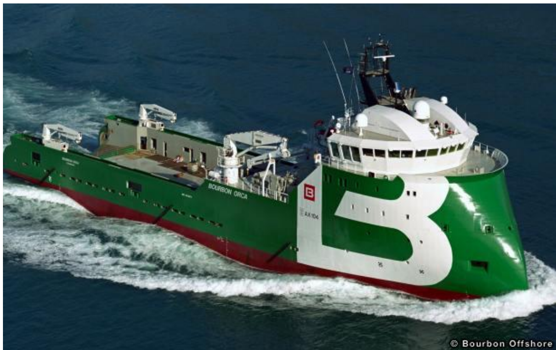
Obr. 31: Norské vlečné a zásobovací plavidlo Bourbon Orca s přídělí X-bow[81]
