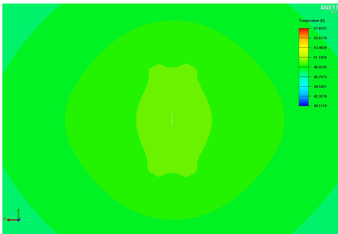
Obrázek 18: Detail spodní vrstvy pod pájecí ploškou 2VDPS se 4 prokvy 0,25
