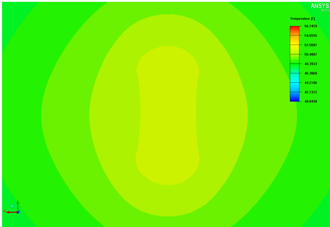
Obrázek 33: Detail spodní vrstvy pod pájecí ploškou 2V DPS se 4 řadami 0,25 mm prokůvů na obou stranách
