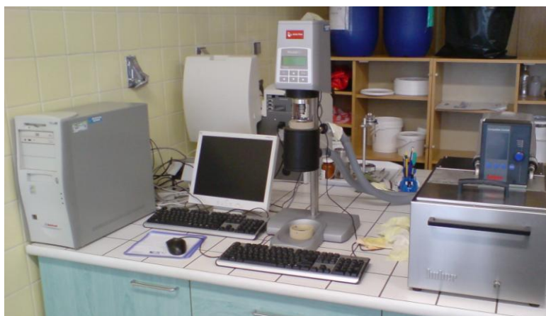
Obr. 6.5 Rotační viskozimetr s jednotkou pro ohřev/chlazení kapaliny
