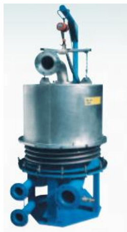
Obr. 7.2 Ukázka šroubovicového výměníku tepla [18]
