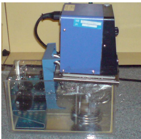
Obr. 6.1 Vodní lázeň s ohříváčem a pyknometry
