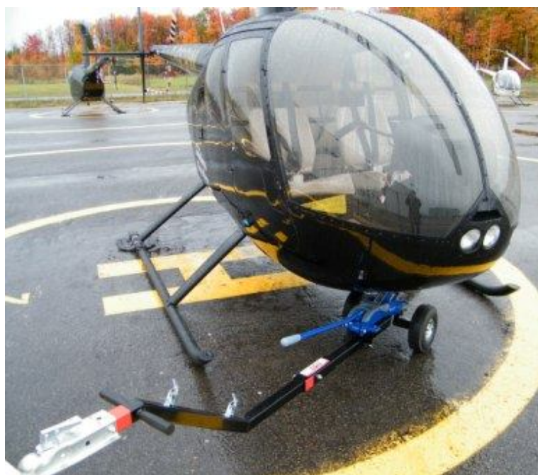
Obr. 17 Tažná tyč pro vrtulník Robinson [11]
