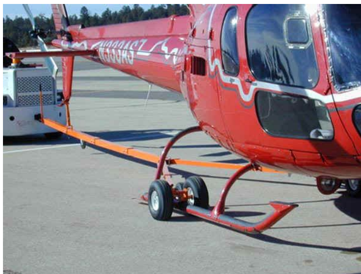
Obr. 31 Tyč Brackett s tažným strojem [16]
