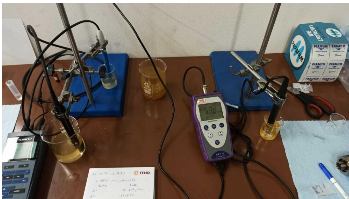
Obrázek 43 Aparatura pro měření vybraných ukazatelů kondenzátu standardními postupy
