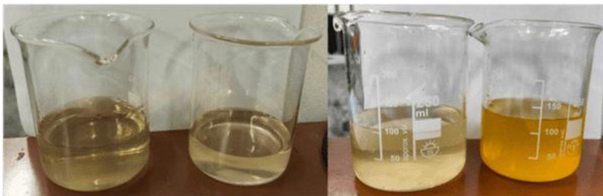
Obrázek 47 Porovnání kondenzátů při nominálním (vlevo) a minimálním (vpravo) výkonu kotle
