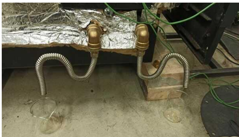
Obrázek 42 Odběr kondenzátu během experimentálního měření
