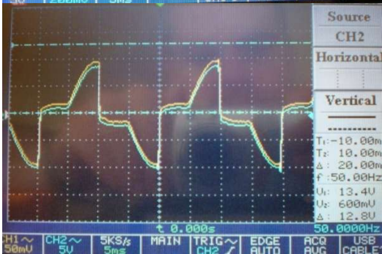
Příloha č. 251 – Vstupní a výstupní proudy a napětí pro nanokrystalický plech při 50Hz a 200% zatížení
