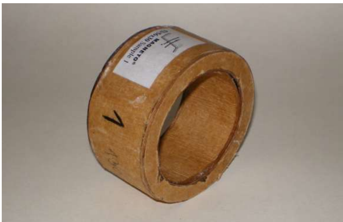
Obr. 7 Toroidní jádro z nanokrystalického materiálu [11]
