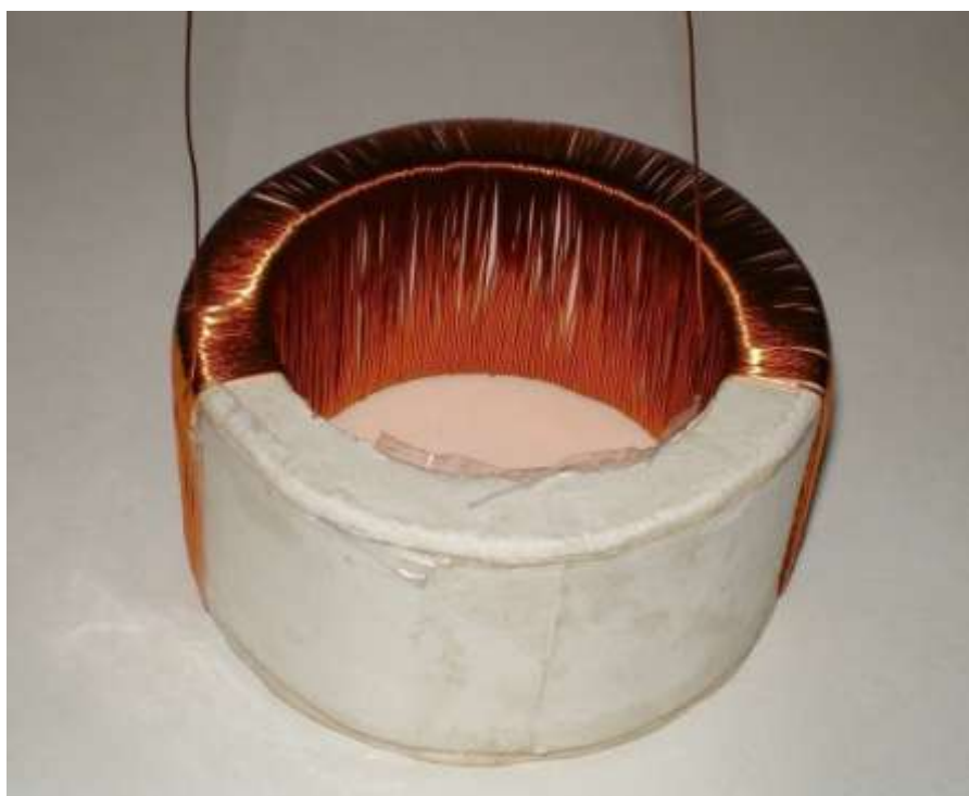
Obr. 8 Toroidní vzorek z elektrotechnického plechu s obojím vinutím A [11]
