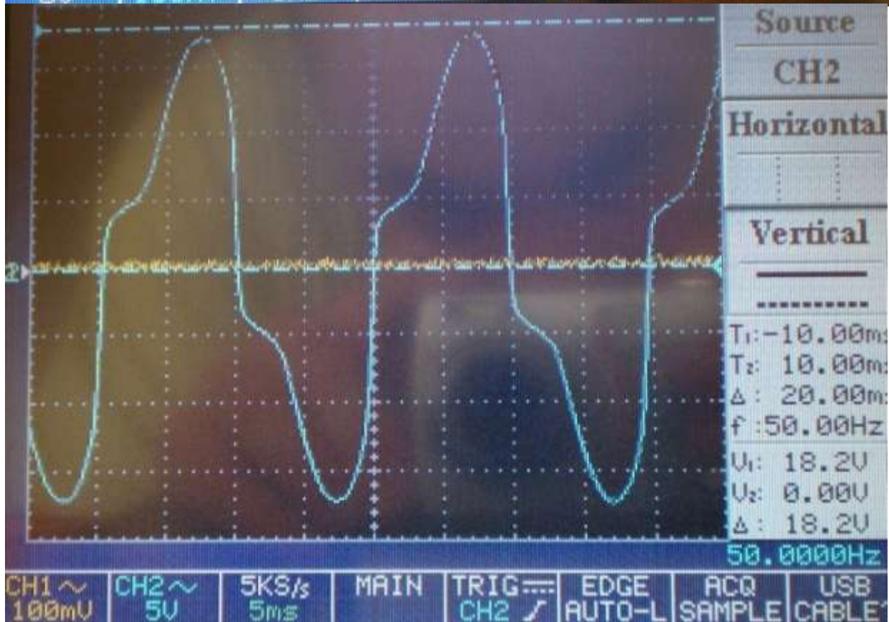
Příloha č. 1 – Vstupní a výstupní proudy a napětí pro elektrotechnický plech při 50Hz a chodu naprázdno
