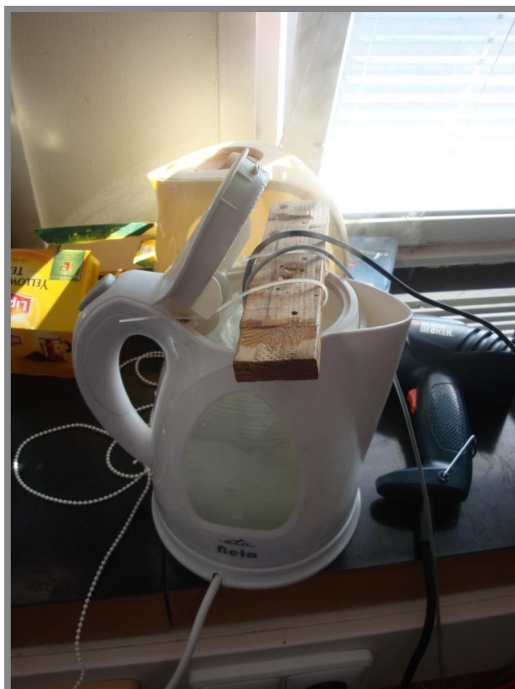
Obr. I.7 Kalibrace ve vařící vodě
