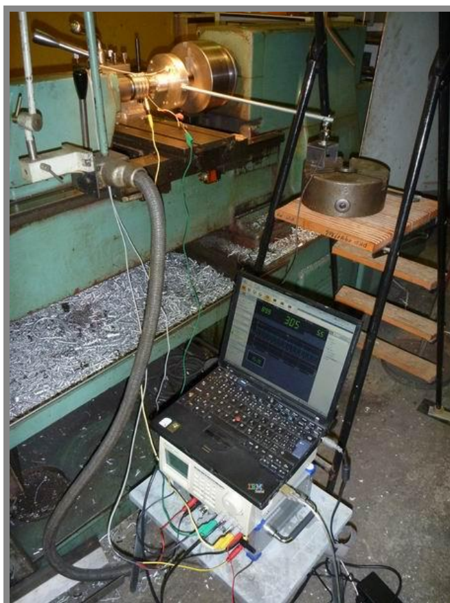
Obr. 7.17 Experimentální měření kroutícího momentu
