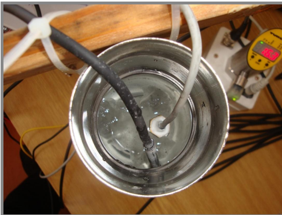
Obr. I.6 Kalibrace v ledové vodě
