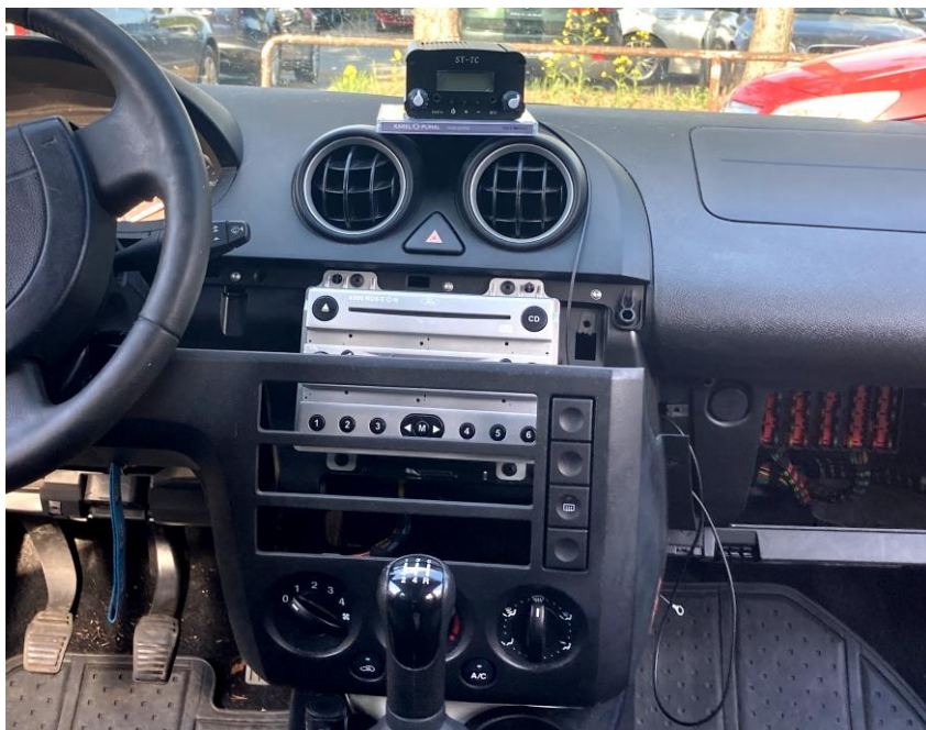
Rozebrané rádio - z procesu zapojení vysílače na interní anténu auta
