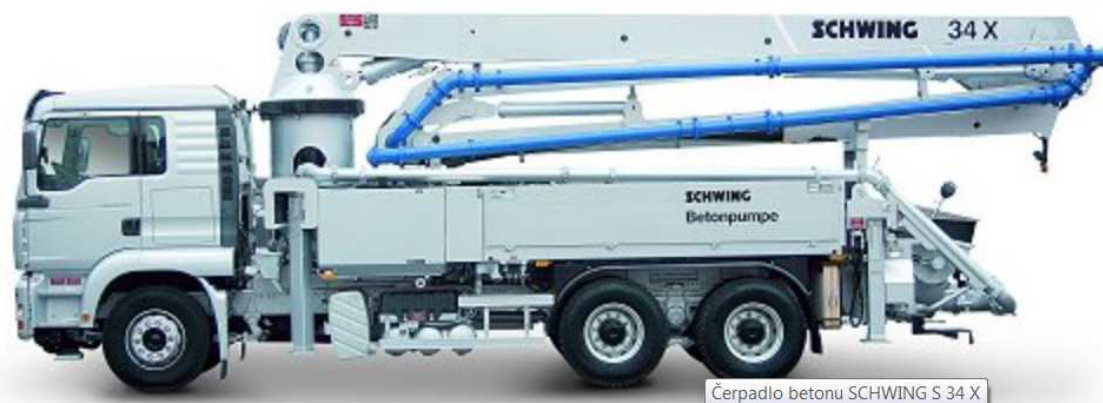
Obr. 29. Betonové čerpadlo na podvozku MAN TGS 6x4 nástavba Schwing S 34X
