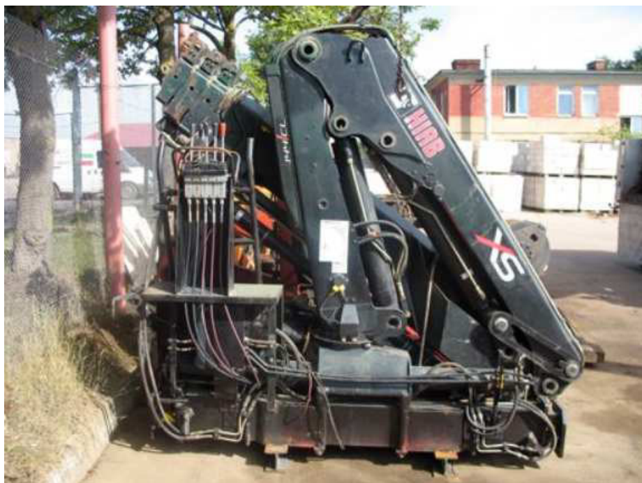
Obr. 21. Hydraulická ruka HIAB XS 144 E-5 HiPro
