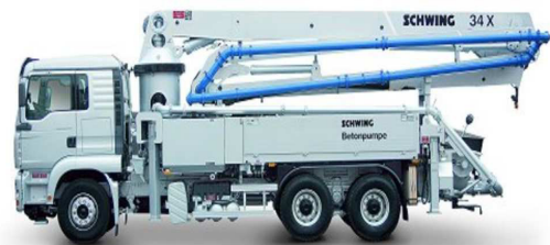
Obr. 11. Betonové čerpadlo na podvozku MAN TGS 6x4 nástavba Schwing S 34X
