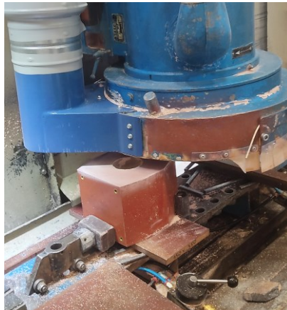
Obr. 17 Strojní broušení povrchu transformátoru zalitého vakuovou technologií.
