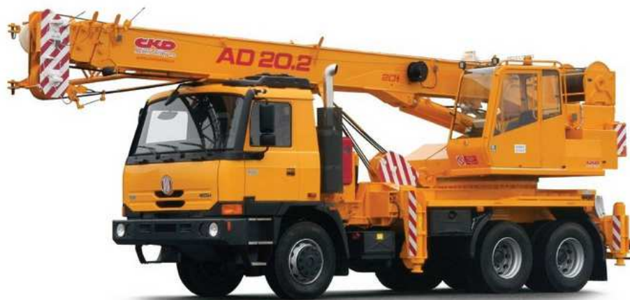
Obr. 37 Autojeřáb Tatra AD 20.2
