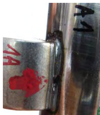
Obr. 6.10 Úchyt s pórem ve svaru.
