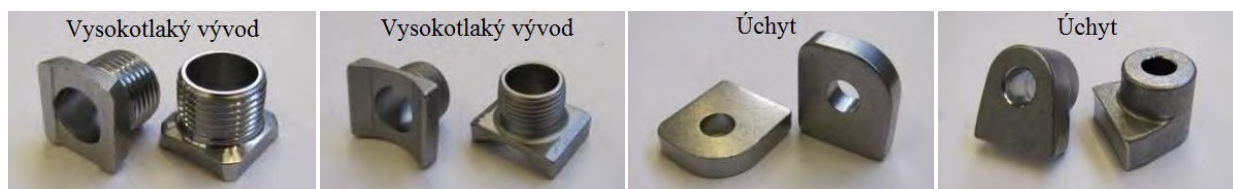
Obr. 4.8 Příklady navařovaných komponentů 2 .
