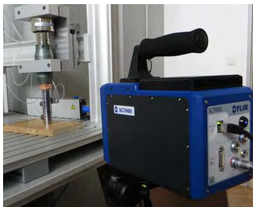
Obr. 6.7 Snímací IR kamera 18 .
