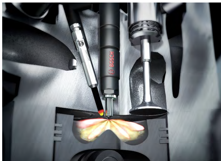
Obr. 2.4 Umístění vstříkovače v hlavě válce 2 .
