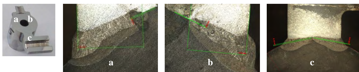
Obr. 6.26 Leptaný vzorek B a jeho vyhodnocení 19 .
