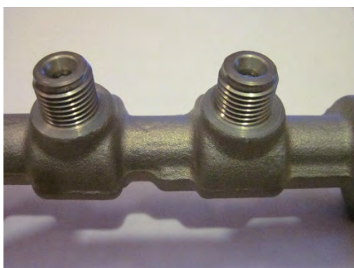
Obr. 3.7 Vysokotlaké vývody HFR 2 .
