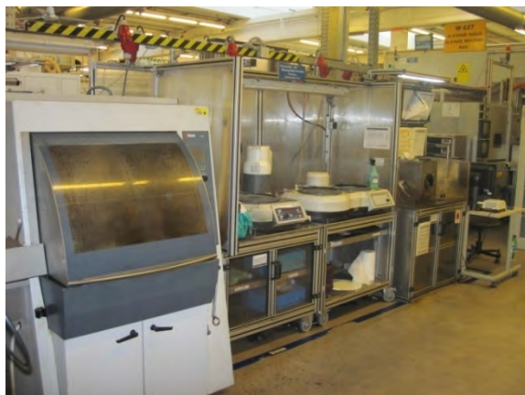
Obr. 5.2 Pila, broušení a leštění 7 .
