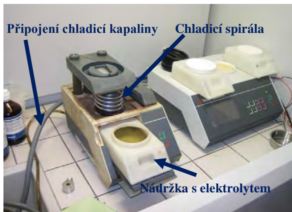
Obr. 6.19 Založení nádrčky s elektrolytem 19 .
