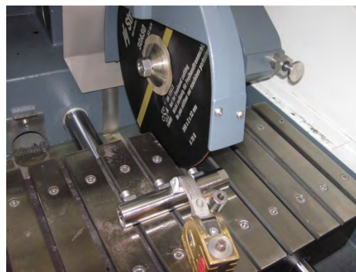
Obr. 6.17 Řezání vzorků pro testy 19 .
