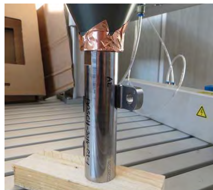
Obr. 6.6 Upnutí vzorku pod budicí hlavou 18 .
