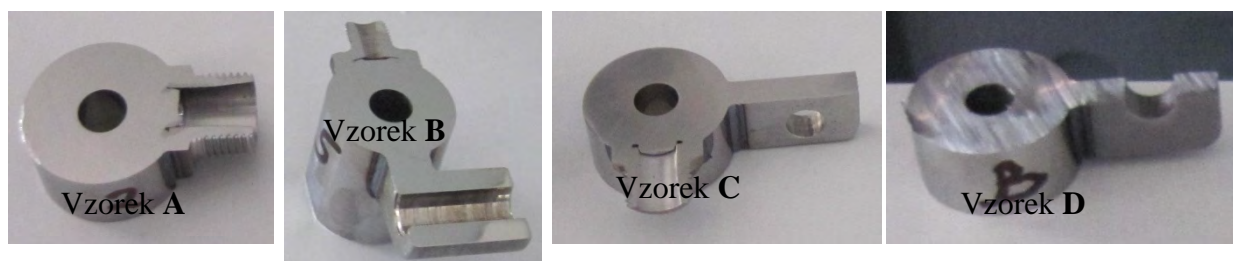
Obr. 6.18 Vzorky A,B,C,D pro elektrochemické leštění 19 .
