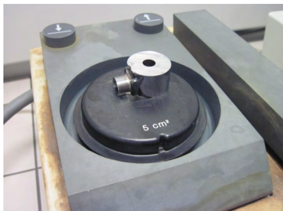
Obr. 6.23 Založení vzorku na šablonu 19 .
