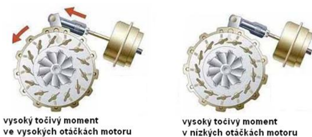
Obr. 10 Princip změny geometrie turbínové skříně [7]
