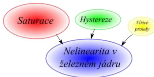
Obr. 2.17 Převážné vlivy na nelinearitu v železném jádru
