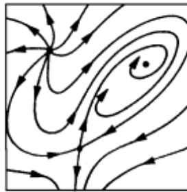
Obr. 2.2 Příklad fázového portréту nelineárního systému s nestabilním a sedlovým kritickým bodem a stabilním ohňiskem.
