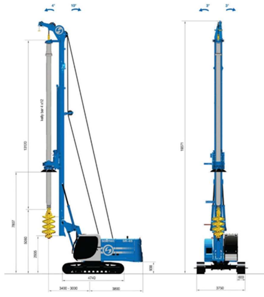
Obrázek č. 31: Vrtná souprava Soilmec SR-45
