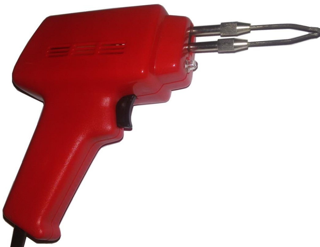
Obr. 2.3 Fotografie modifikované transformátorové páječky
