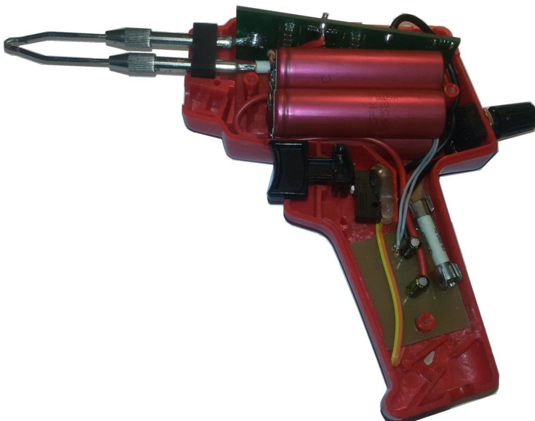
Obr. 5.12 Fotografie celkové bateriově napájené páječky
