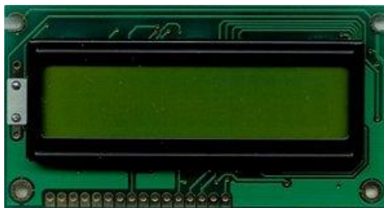
Obrázek 21: LCD displej MC1602E-SYL/H použitý v modelu EZS [15]
