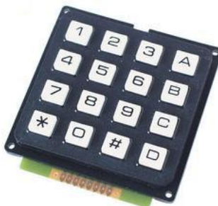
Obrázek 19: Maticová klávesnice 4x4 použitá v modelu EZS [21]
