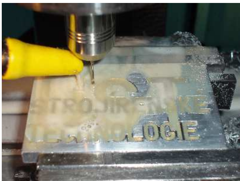
Obr. 4.6 Ukázka dokončování pomocí Mikro-N-Cut.
