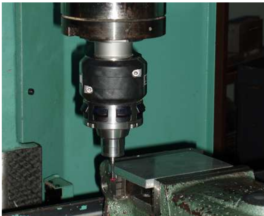
Obr 4.5 Určení nulového bodu obrobku pomocí dotykové sondy.
