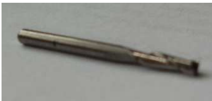
Obr. 4.2 Drážkovací dvojbřitá fréza.
