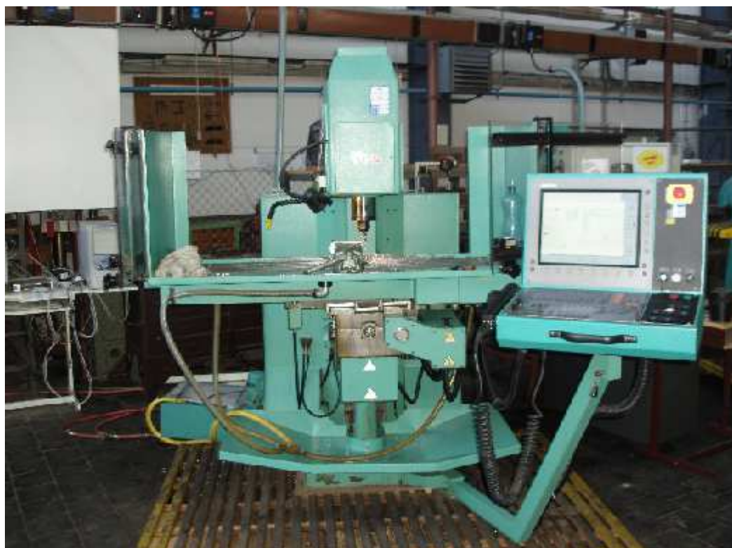
Obr. 4.4 Konzolová vertikální frézka FV 25 CNC.
