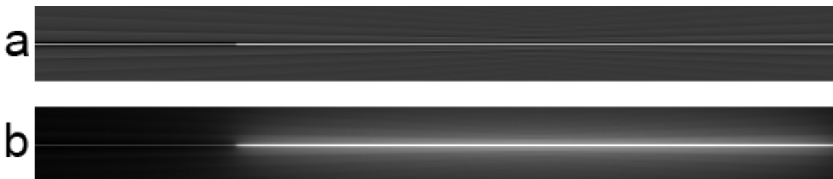
Obrázek 51: Srovnání výřezů obrazů rekonstruovaných ze souboru projekcí, kde byl jako rekonstrukční filtr využit Ram-Lakenův filtr (a) resp. byla provedena přímá zpětná projekce (b); parametry PZ: trasa 3 (zásun zprava do hloubky 192 mm), prostá normalizace snímků, frekvence prezentace obrazu 6 obr./s, rychlost zásunu 60mm/s, rychlost rotace gantry 360°/s, 360 projekcí/rotace, 6 sektorů
