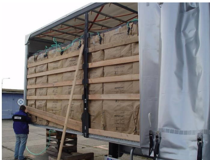
Obr. 12 Vaky pro vyvození tlaku na bok návěsu
