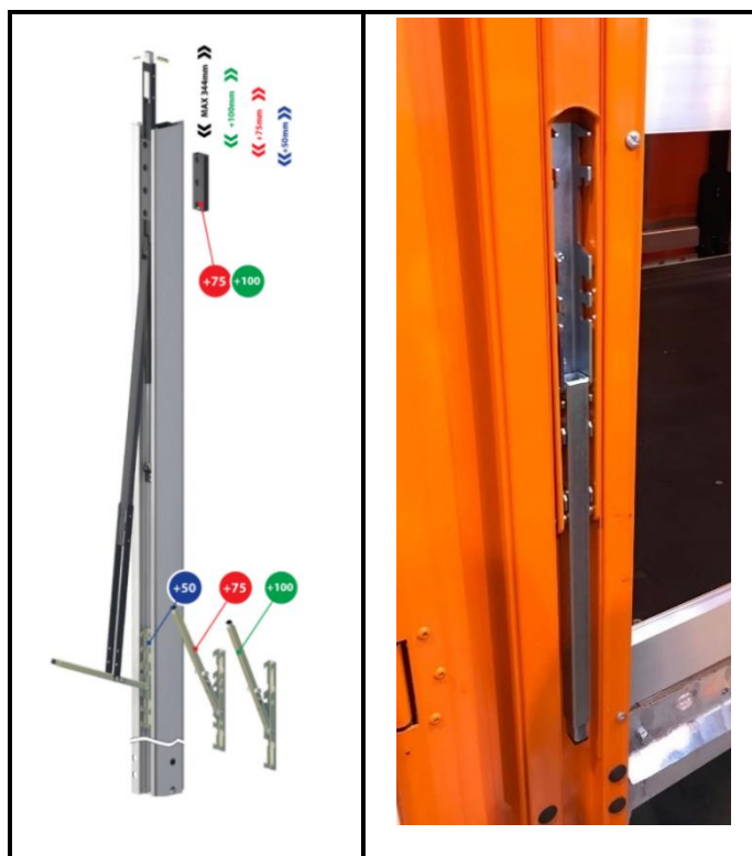
Obr. 5 Ukázka zvedání střechy HERCULES [6] [7]
