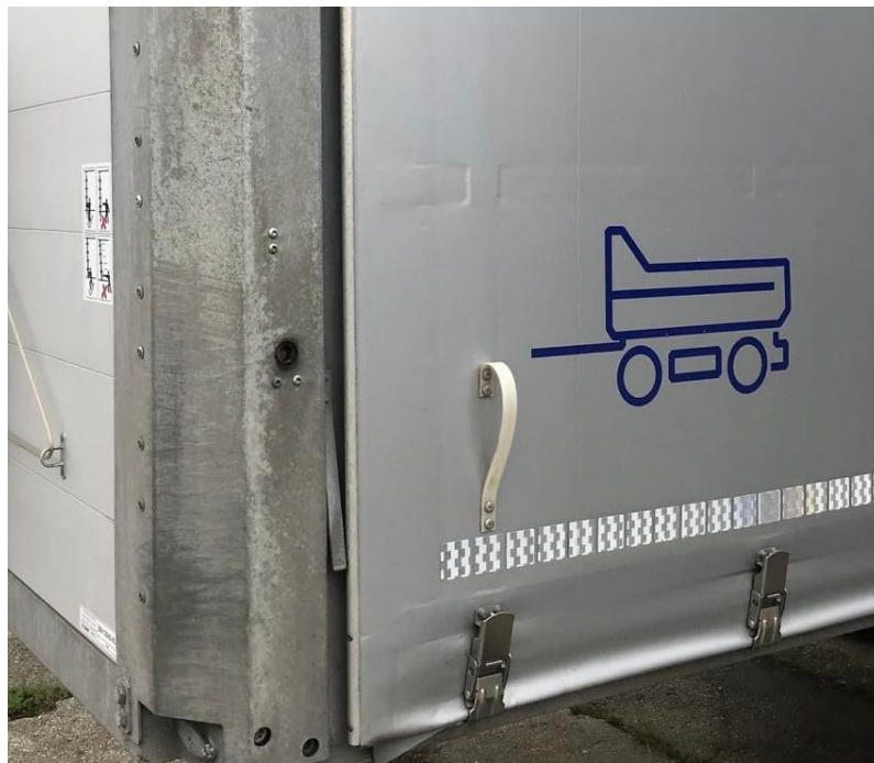
Obr. 7 Návěsový sloupek a zarážka pro plachtu
