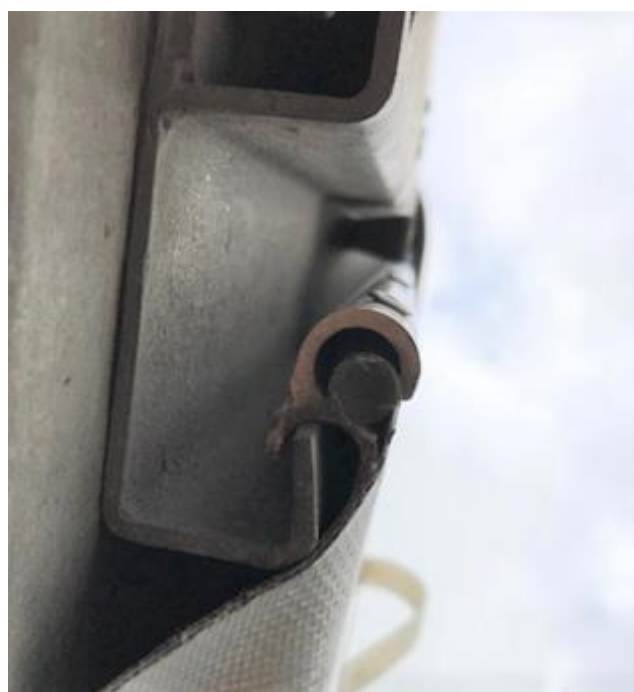
Obr. 8 Hliníkový protikus a zarážka pro plachtu ze spodu
