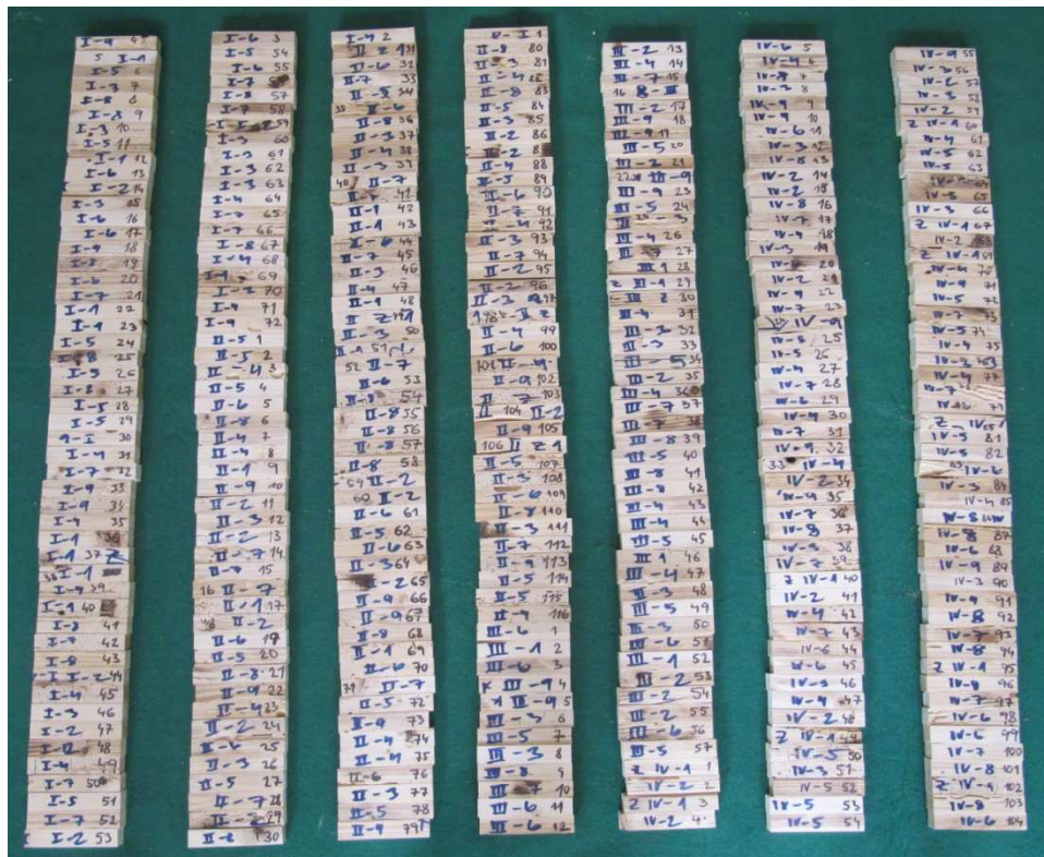
Obr. 47 Přehled zkušebních vzorků získaných z trámu
