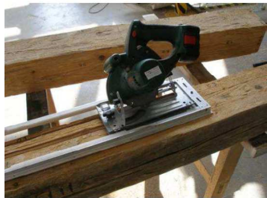
Obr. 25 Příprava tahových mikrovzorků [10]
