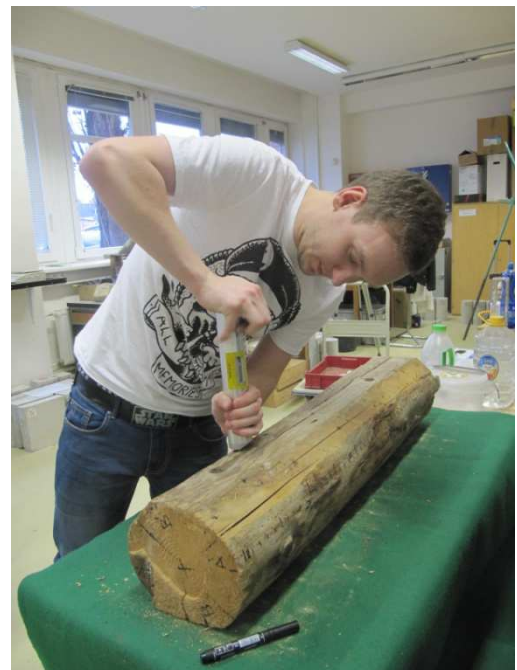
Obr. 19 Provádění zkoušky odporového zarážení trnu
