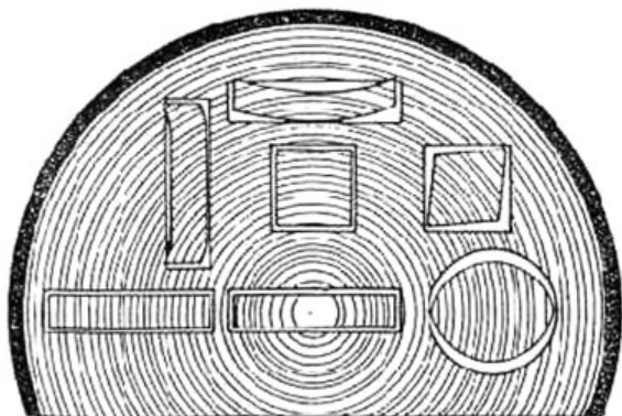
Obr. 13 Různé druhy deformací řeziva při sesychání [1]
