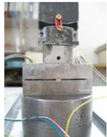
Obr. 22 Zatěžovací zkouška radiálního vývrtu [20]
