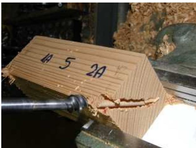
Obr. 21 Odebírání radiálního vývrtu [20]
