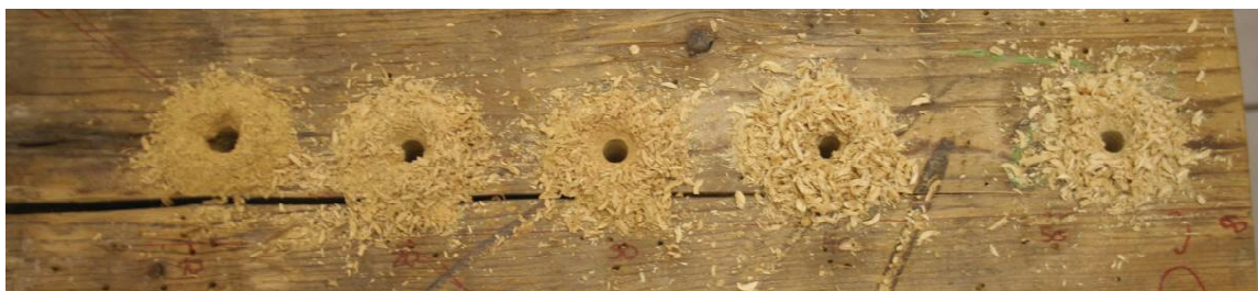
Obr. 23 Vrty s různou kvalitou pilin [5]
