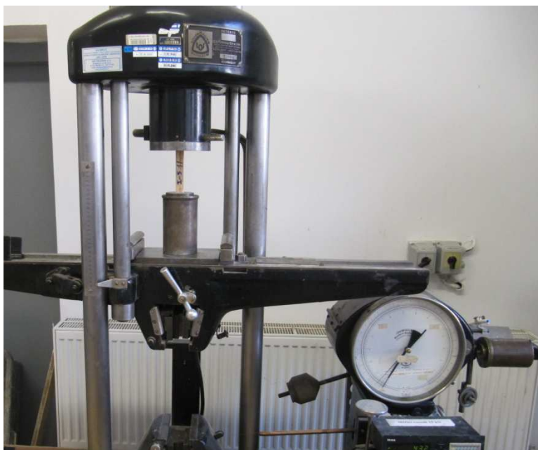
Obr. 48 Zkoušení vzorku na pevnost v tlaku rovnoběžně s vlákny
