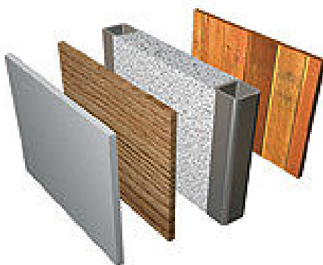
2.2 skladba sendvičového panelu
