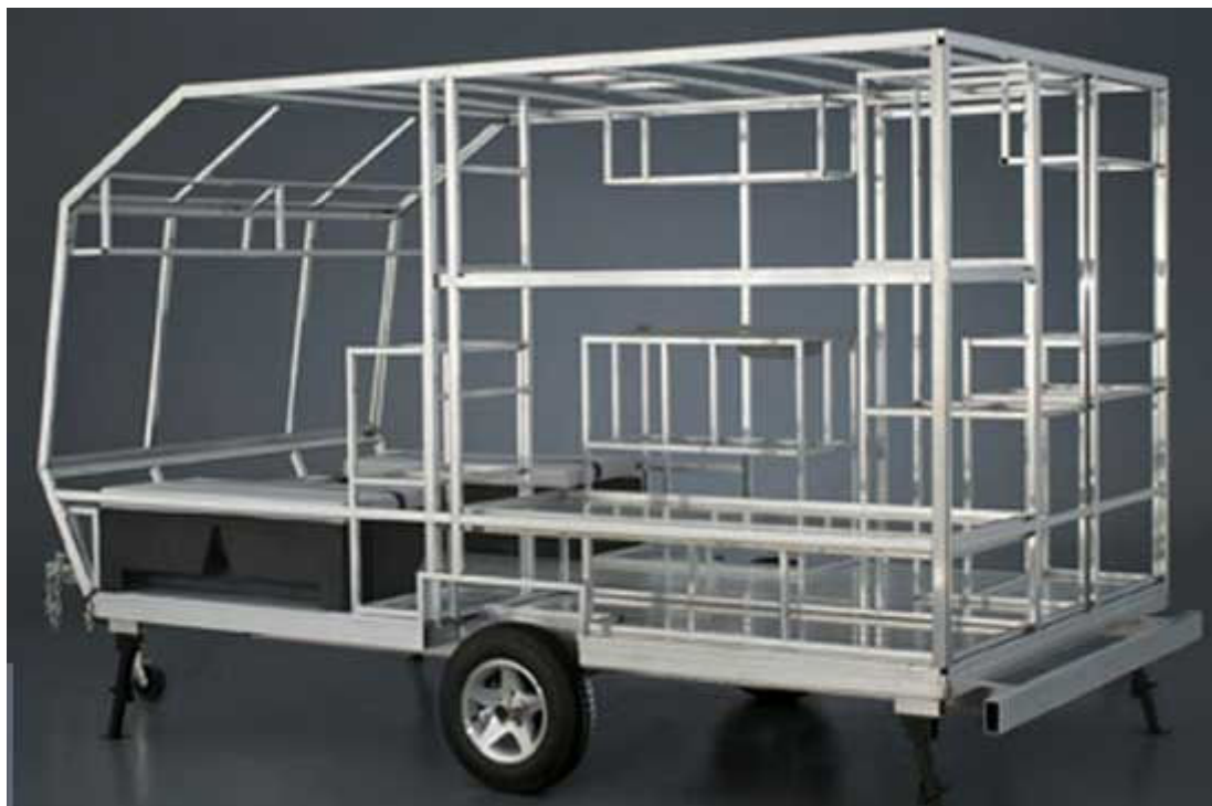
2.1 Kovová konstrukce přívěsu
