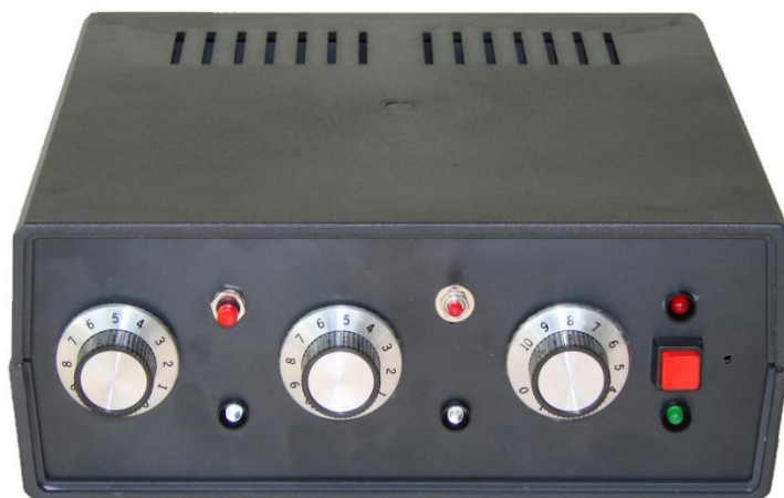
Obrázek 45: Přední panel audiometru
